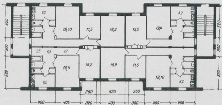
План соединительной вставки в сочетании с торцами двух блокируемых домов
