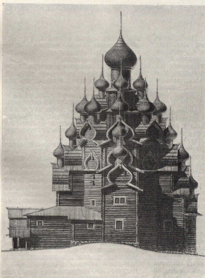
Преображенская церковь на Кижском погосте Карело-Финская ССР (Заонежский район). 1714 год. Проект реставрации. Автор архитектор А. Ополовников. 1949 г. Консультант профессор Д. Сухов. 1 — Главный западный фасад; 2 — продольный разрез; 3 — южный фасад; 4 — деталь кровли 4 яруса
