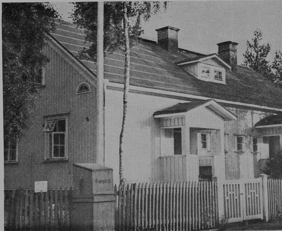
Вверху: каркасно-засыпной дом в г. Сальми. Засыпка — опилки со стружками. Драночная кровля покрашена красной краской. Печное отопление
