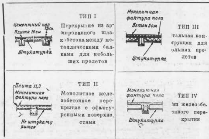
Рис. 15. Варианты конструкций типовых перекрытий
