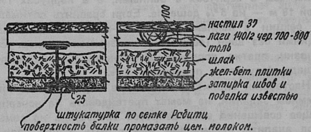
Перекрытие на металлических балках
