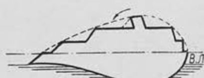
Схема № 6 „Двусторонняя лестница“, вписанная в каплю
