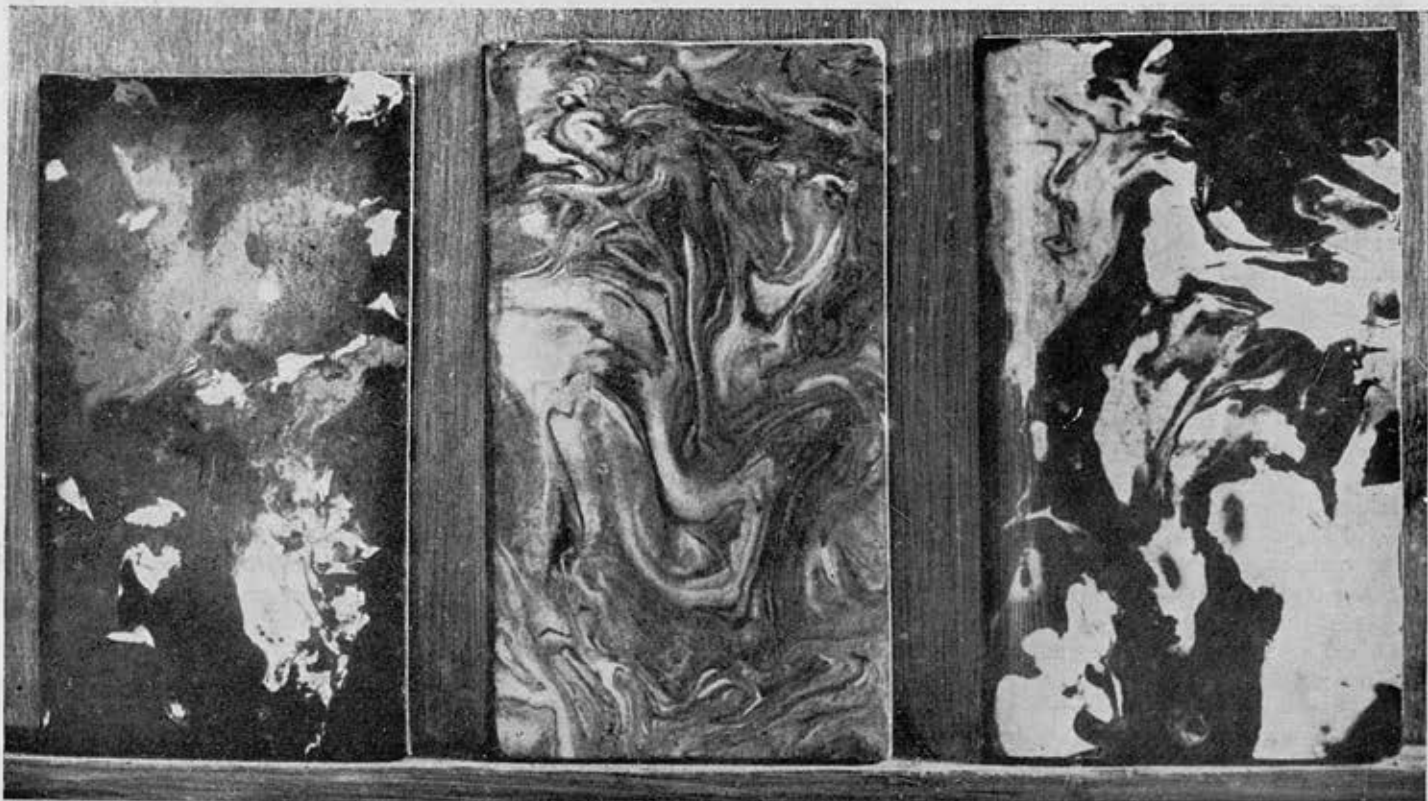
Placage de revêtement en grès cérame (imitation du marbre naturel) Fabrique de dalles et de céramique (Moscou)
